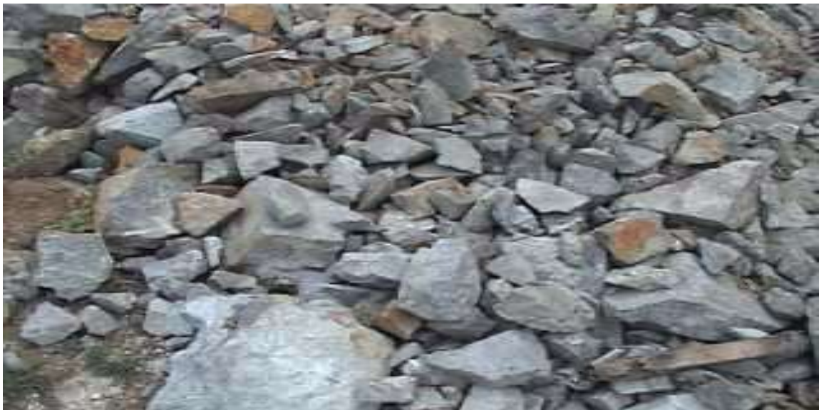
Foto No 11 escombros resultantes de voladuras de los frentes de explotación.
