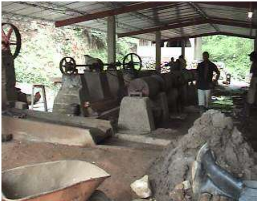
Foto No 37 planta de trituración, molienda y concentración gravimetrica el Carmín.
